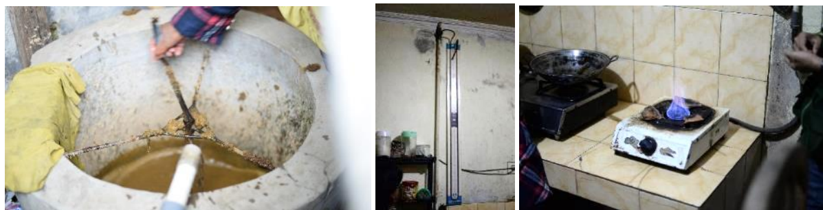
Gambar 4. Pembuatan biogas dari kotoran sapi.
