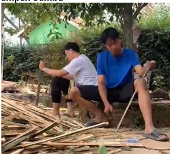
Gambar 4. Proses pembuatan tong sampah bambu
