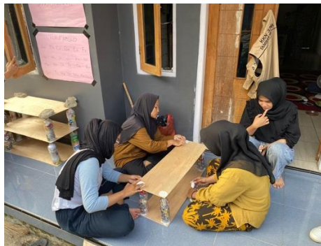
Gambar 2. Pembuatan Sampah Ecobrick Menjadi Rak Sepatu
