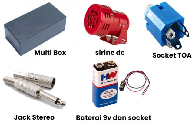
Gambar 5. Bahan-bahan yang perlu disiapkan untuk membuat alat deteksi dini tanah longsor
