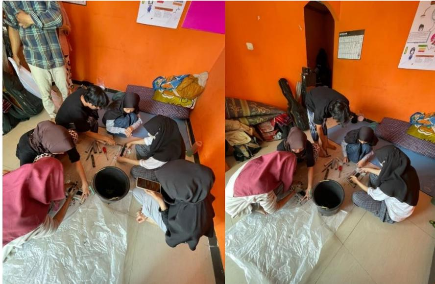
**Gambar 11.** Proses pencetakan briket dari arang sekam
