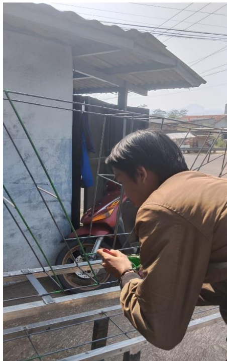
Gambar 4. Proses pembuatan besi penyanggah ecobrick
