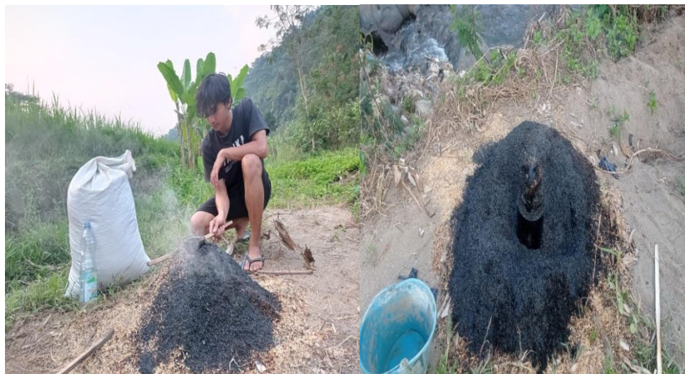
Gambar 9. Proses pembakaran limbah sekam padi hingga menjadi arang
