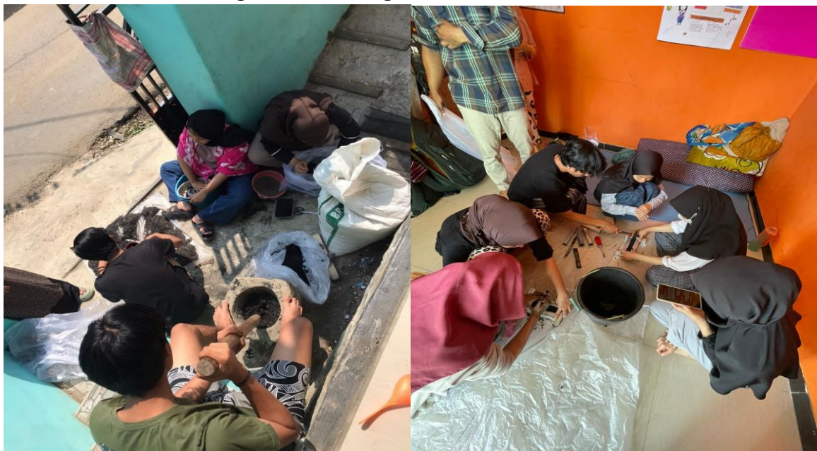
Gambar 6. Proses penumbukan, pencampuran dengan tepung kanji dan pencetakan arang sekam
