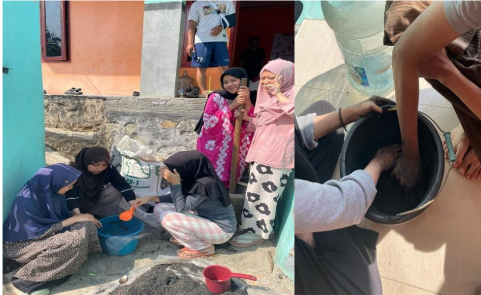
Gambar 10. Proses penghalusan, pengayakan, dan pencampuran arang sekam dengan tepung kanji
