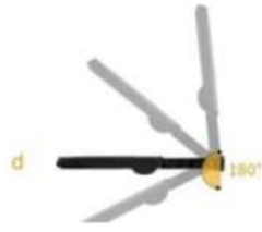
Gambar 3. Pengaturan sudut kemiringan lampu
