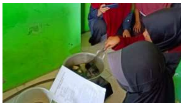
Gambar 9. Pencampuran Minyak Jelantah dan Parafin
