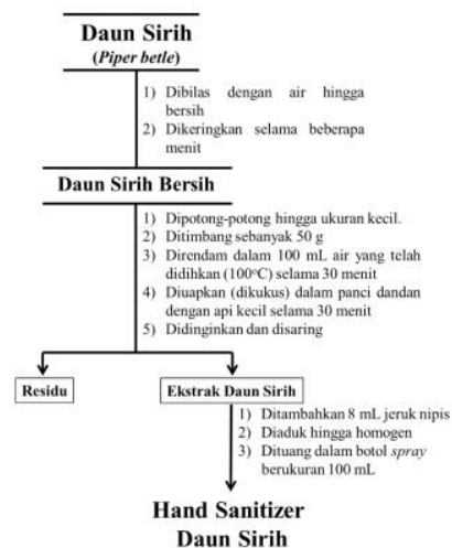
Gambar 1. Tahapan pembuatan hand sanitizer daun sirih . (Adinda, Nur Sholikhah & Riva Ismawati, 2020).
